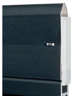
**Embout latéraux** en polyamide pour un guidage optimal dans la coulisse, fixés à cette dernière par une agrafe antirouille et renforcés pour une meilleure résistance au vent.
